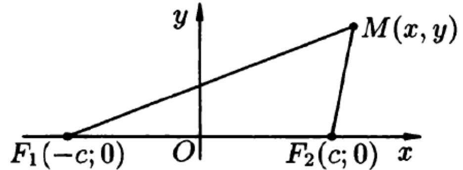
**1.** Уравнение (12.6) содержит  $x$  и  $y$  только в четных степенях, следовательно, гиперболой симметрична относительно осей  $Ox$  и  $Oy$ , а также относительно точки  $O(0; 0)$ , которую называют центром гиперболы.
