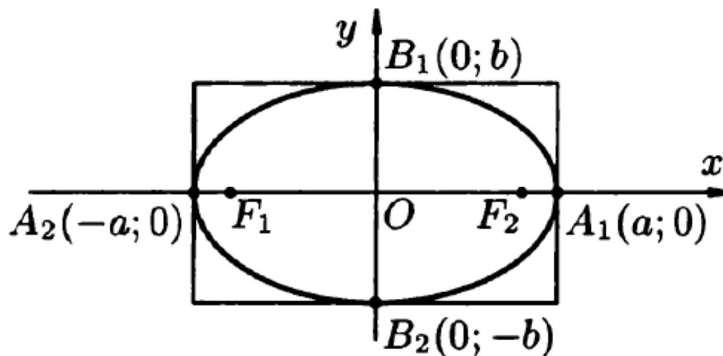
Отрезки  $A_1A_2$  и  $B_1B_2$  и их длины  $2a$  и  $2b$  называются соответственно **большой и малой осями** эллипса. Числа  $a$  и  $b$  – **полуоси** эллипса,  $a$  – **большая полуось**,  $b$  – **малая полуось** (так как  $b = \sqrt{a^2 - c^2} < a$ ).
