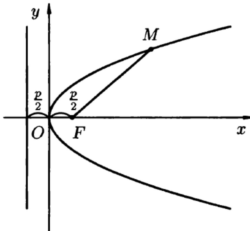
Уравнения:  $y^2 = -2px$ ,  $x^2 = 2py$ ,  $x^2 = -2py$ , ( $p > 0$ ) также определяют параболы:
